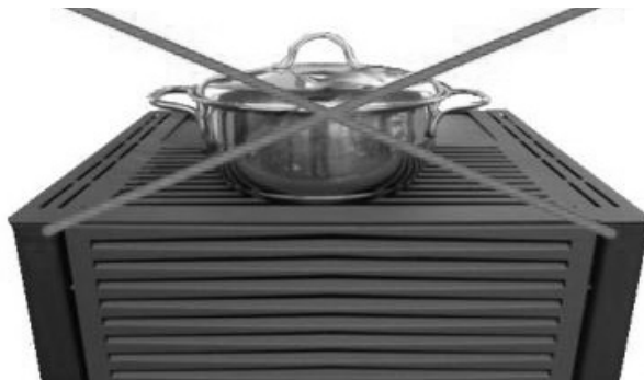
Fig. 22 - Nie przykrywać szczelin powietrza
